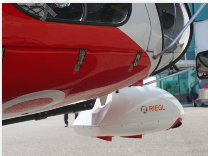
在 Airbus AS350 直升机上安装的 VQX-2 直升机吊舱
